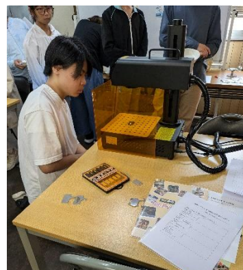
端材にロゴをレーザー加工
